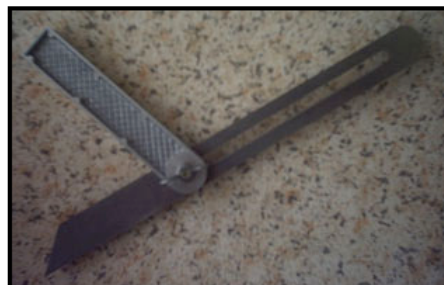
Figura 4: Suta, instrumento utilizado pelos calafates em Câmara de Lobos
