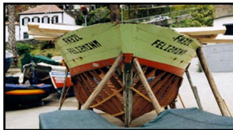
Figura 3: Barco em construção
